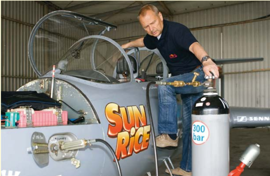
Walter Eichhorn füllt beim Pre-Flight-Check der L-29 Druckluft zum Starten der Rolls-Royce-Turbine nach.
