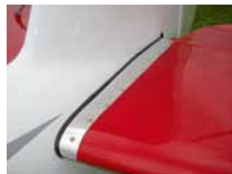
Liebe zum Detail: hochganzpolierte Abschlussbleche mit Kedern an den Höhenflossen.
