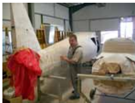
Von Grund auf: Die Aussenhaut des Rumpfes wurde ebenfalls komplett abbeizt.
