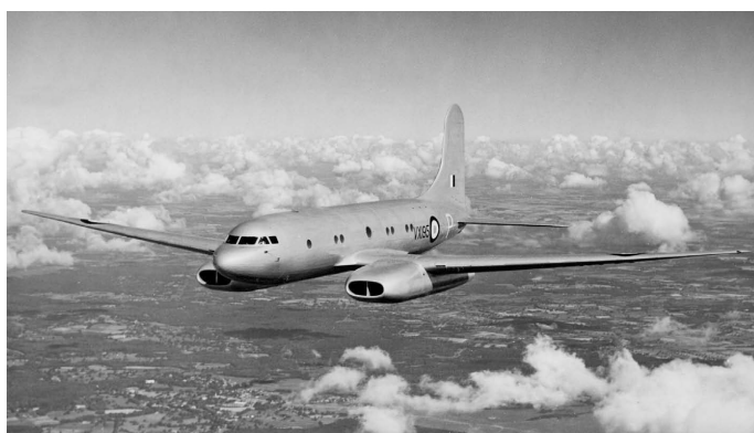
Erstflug des Experimentalflugzeuges Tudor 8 am 7. September 1948. Trotz guter Flugleistungen wurde die mit vier Rolls Royce Nene bestückte und mit Bugfahrwerk versehene Maschine lediglich für Forschungszwecke verwendet.
