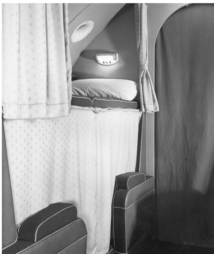
Die komfortablen Sitze der Tudor 1 für zunächst lediglich zwölf Passagiere wurden auf Nachtflügen zu Schlafkojen umgebaut, dezente Vorhänge inklusive!
