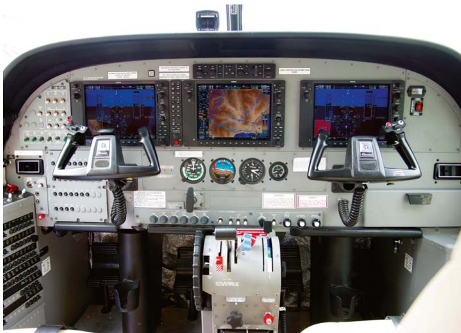
Das Garmin G1000 Glascockpit mit Autopilot sorgt für Übersicht und erleichtert die Arbeit.
