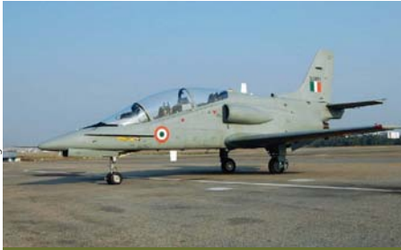
Am IJT-36 Sitara verbessern nun Strakes entlang der Nase die Stabilität.
