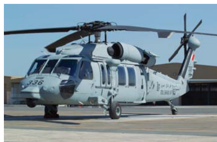
Die Hauptaufgabe der Sikorsky S-70M Blackhawk besteht in Search and Rescue. Der abgebildete Helikopter verfügt dafür über verschiedene Sensoren an der Nasenspitze.
