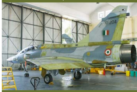
Die Ingenieure in Bangalore loben die Struktur der Mirage-2000; beim 2. Overhaul sind nahezu keine Materialermüdungen zu verzeichnen.
