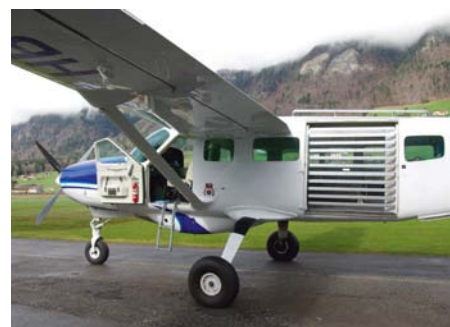
Der «Rollladen» erleichtert den Absprung.
