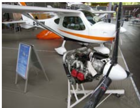
Hybridmotor von Flight Design: Zu den 115 PS des Rotax 914 kommen weitere 40 PS des Elektromotors.
