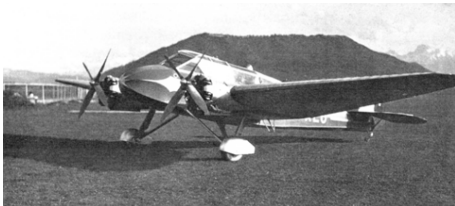
Frontansicht der Monospar ST-4; serienmässig bestückt mit zwei je 85 PS leistenden Pobjoy-R-Motoren.
