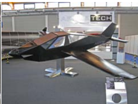
Im Stealth-Jäger-Look: Der Prototyp von Aero&Tech ist unter der Cowling eher konventionell, dort soll ein Rotax 912S für Power sorgen.
