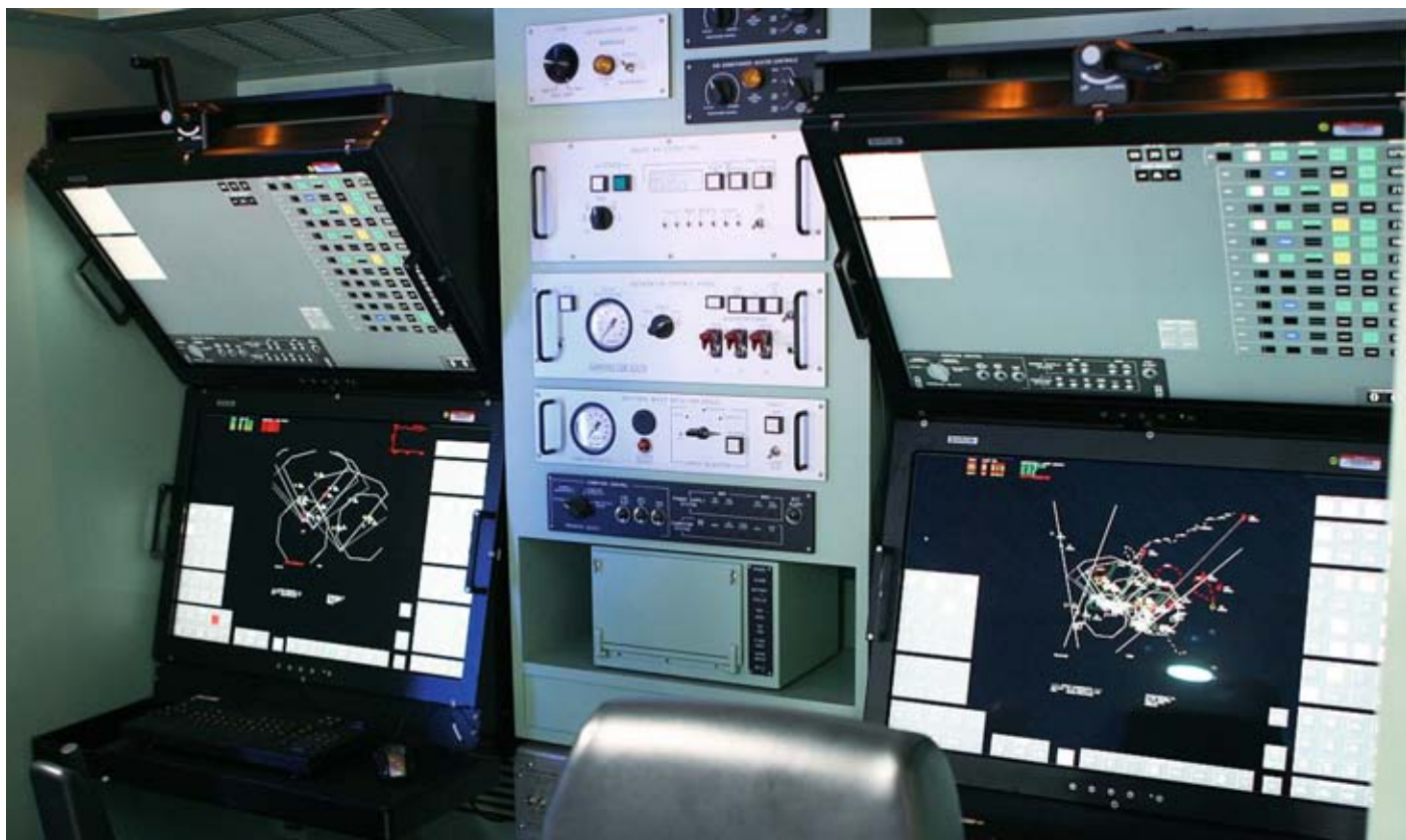
Arbeitsplätze im Kommandoshelter einer PAC-3 «Patriot»-Einheit. Das System kann mit seinem (meist masterhöhen) AN/MPQ-53 bzw. -65 TER-Feuerleitradar im Frequenzbereich 4 bis 8 GHz 90 Ziele verfolgen und 9 davon zwischen 3 und 170 km entfernt simultan bekämpfen.
