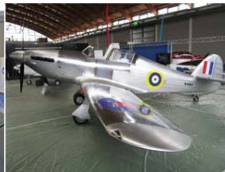
Hawker Hurricane-Replika: Ein MTOW von 595 kg und eine Vne von 288 km/h zeichnen den Mini-Warbird aus.
