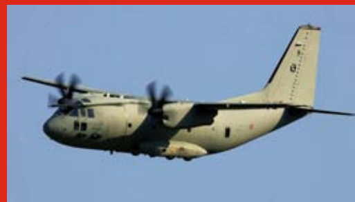
Die Alenia C-27J Spartan ist ein mittlerer militärischer Mehrzwecktransporter mit Kurzstart-Eigenschaften (STOL) und trägt den liebevollen Spitznamen «Baby Herc».
