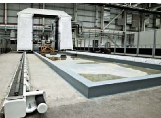
Ein Ultraschallscanner führt die Nondestructive-Tests der Flügelteile durch.
