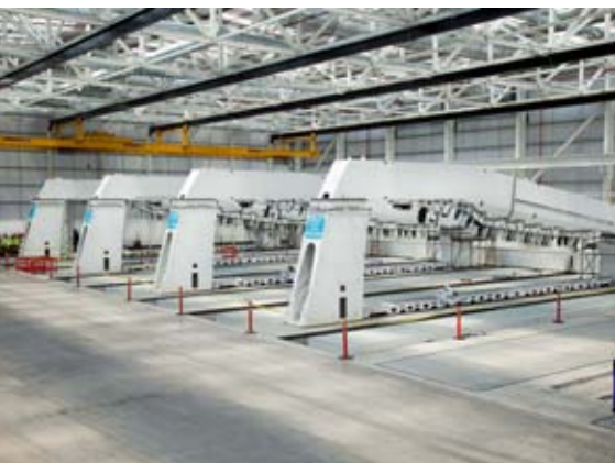
Auf diesen Gestellen im Werk Belfast werden die Tragflächen der C-Series montiert.
