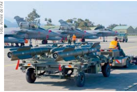
Rafales werden im Rahmen der Operation Harmattan aufmunitioniert. Auf dem Transportwagen befinden sich AASM-Präzisions-Abstandswaffen von MBDA, die mit einem Raketenmotor als Booster ausgestattet sind.
