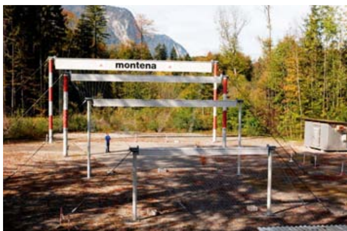
Bild 2: der neun Meter hohe NEMP-Simulator der armasuisse in Spiez, umgebaut von der aus Rossens FR stammenden Firma Montena.
