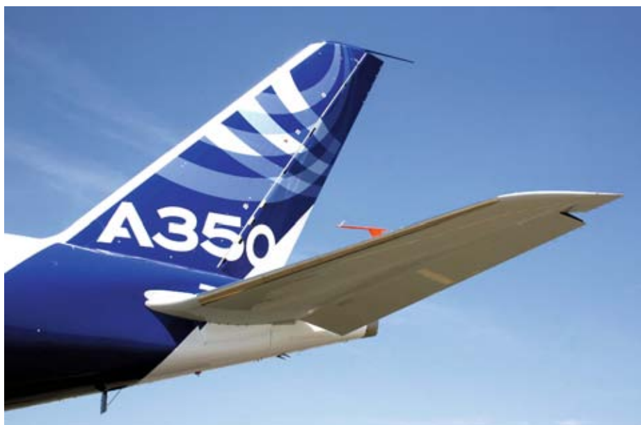
Für die Flugerprobung wurde am Höhenruder ein zusätzlicher Staudruckmesser installiert.
