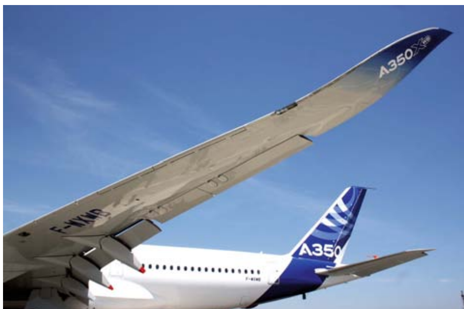
Der A350 verfügt an den Flügelenden über elegant nach oben geschwungene Blended Winglets zur Reduktion des Luftwiderstands.
