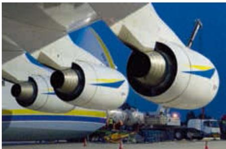
Pro Flügel verfügt die An-225 über drei Lotarjow-D-18T-Triebwerke mit je 229,85 kN Schub.
