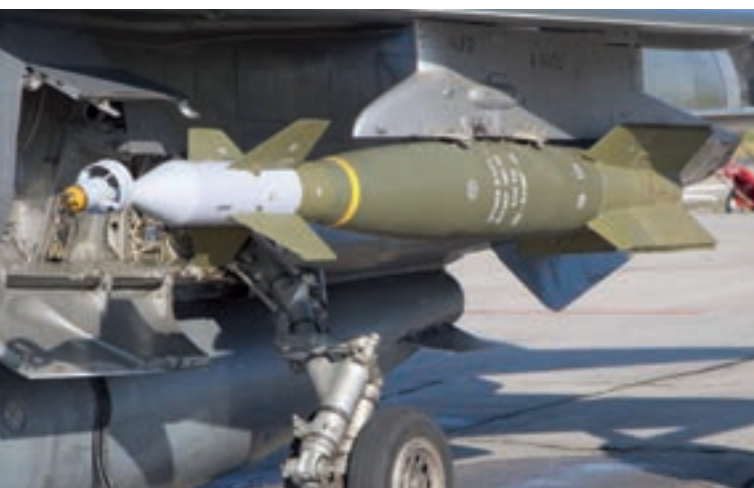
Nahaufnahme der lasergesteuerten Bombe GBU-16 Paveway II, Mk 83 (1000 Pfund, entspricht 454 kg).
