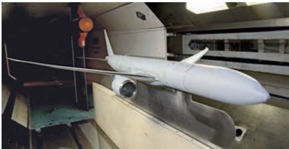
Intensive Tests im Windkanal ergeben Aufschlüsse über die Aerodynamik.
