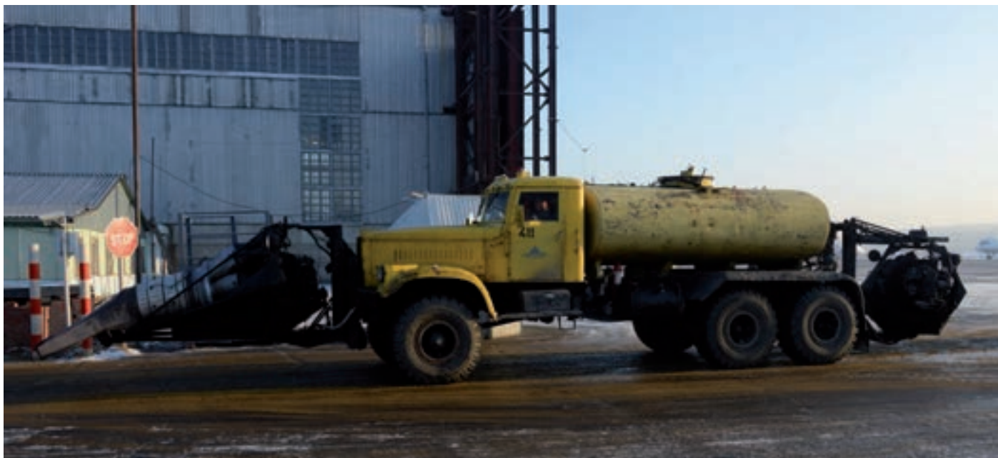
Pistenenteisung auf Russisch: ein Tanklastwagen mit zwei alten Flugzeugtriebwerken, die für Hitze sorgen.
