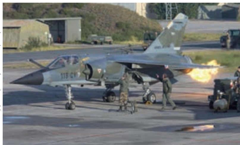
Start des Triebwerks der Mirage F1. Im Triebwerkauslass zurückgebliebener Treibstoff entzündet sich in einer grossen Stichflamme.
