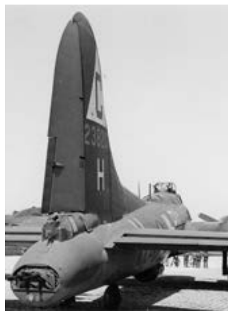
Der Arbeitsplatz des Heckschützen Sergeant George A. Senheiser war mit zwei Browning M2 ausgerüstet.
