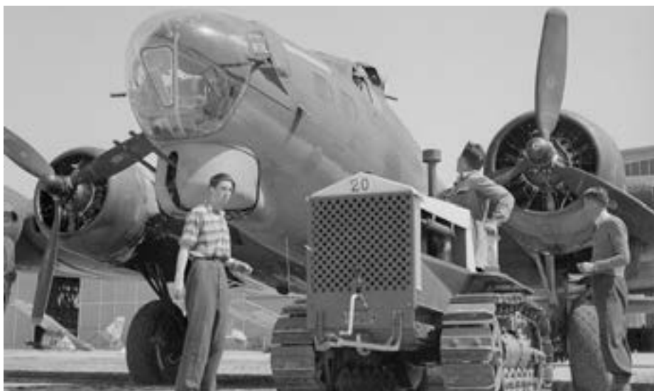
Ein Aebi-Traktor nimmt die bei den Douglas-Werken in Lizenz gebaute B-17 G-30-DL in Schleppe. Typisch für die G-Version der «Fliegenden Festung» war der von Bendix entwickelte Kinn-Dreh-turm mit zwei ferngesteuerten Browning-M2-Maschinenkanonen vom Kaliber 12,7 mm.
