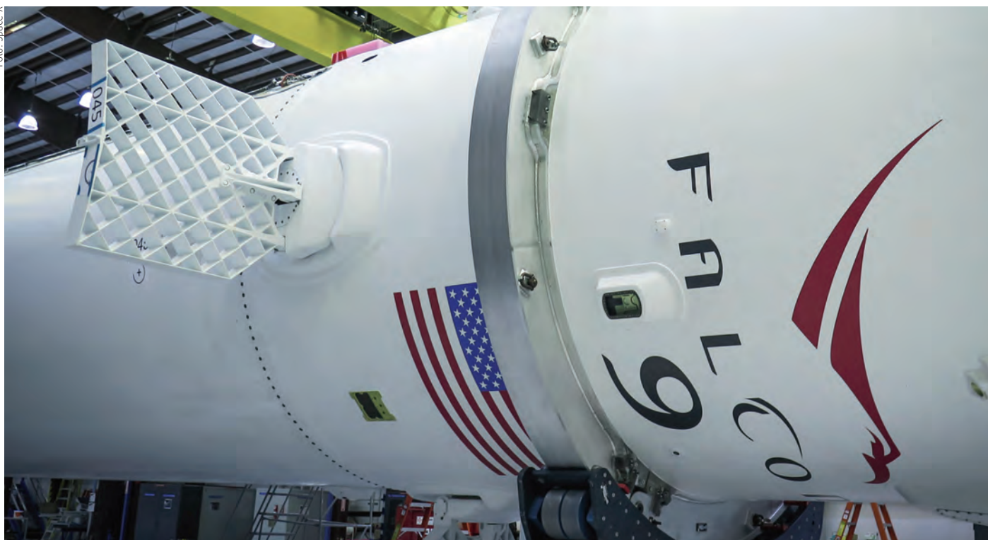
Die Steuerflossen am oberen Ende der 3,66 Meter dicken Erststufe.
