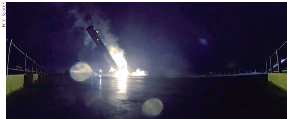
Beim ersten Bergungsversuch wurde die Plattform aus mehr als 160 Kilometern Höhe und über 300 Kilometer Distanz angesteuert, traf sie aber am Rand, wo sie umkippte und explodierte. SpaceX hatte nicht mehr versprochen und veröffentlichte sogar ein Video vom dramatischen Vorgang in finsterner Nacht.
