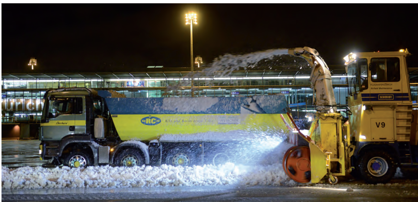
Die Standplätze vor dem Terminal E müssen mit der Schneefräse geräumt werden.
