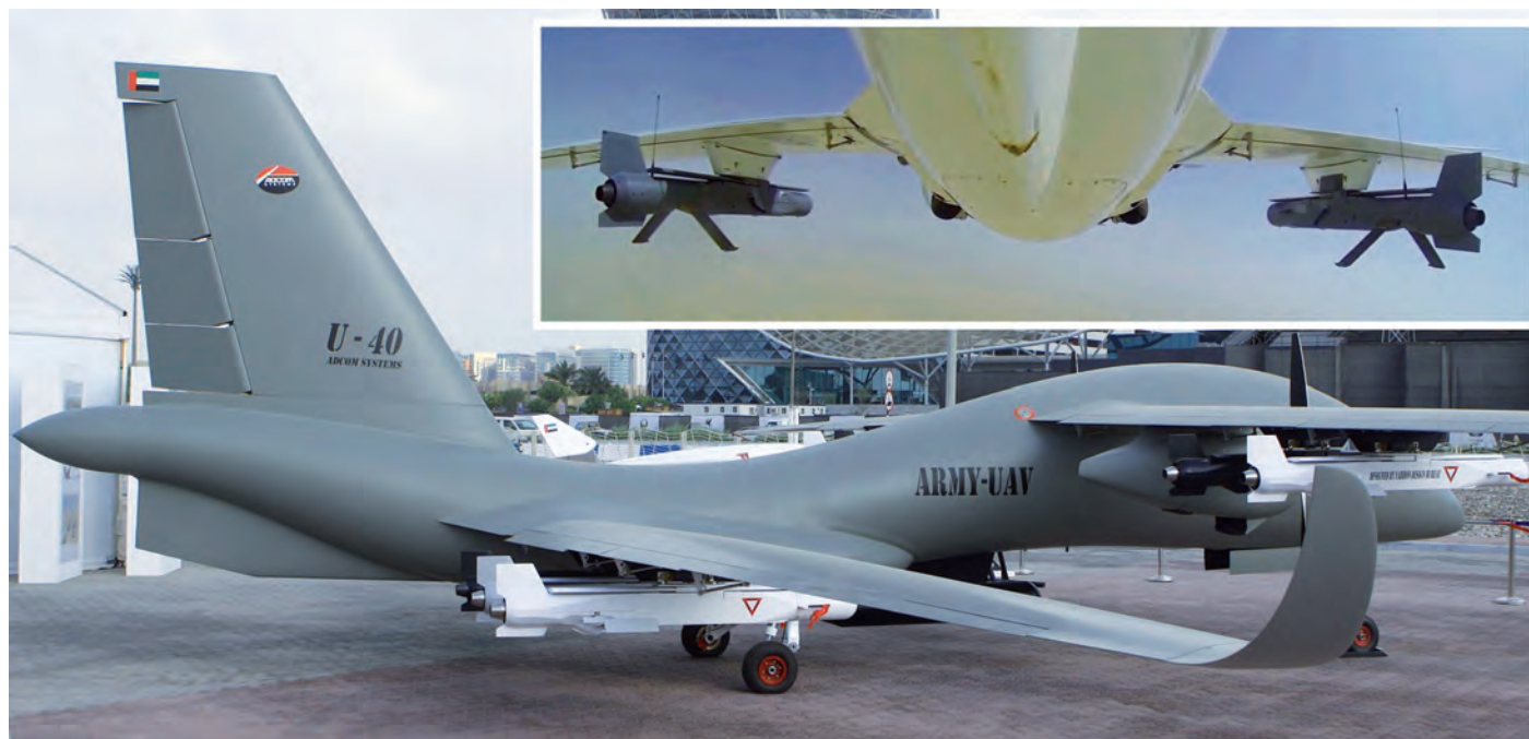
Bis zu 120 Stunden auf Flightlevel 230 soll dieses futuristische UAV (unbemanntes Luftfahrzeug) schaffen, die «United-40» von ADCOM (VAE). Die Designversion fliegt und schießt bereits. Angeblich gibt es drei Kunden. Eine Jet-Version ist im Bau.
