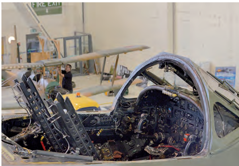
Die Vulcan als Cabrio: Zu Wartungszwecken sind das Cockpitdach und die beiden Schleudersitze manchmal ausgebaut.
