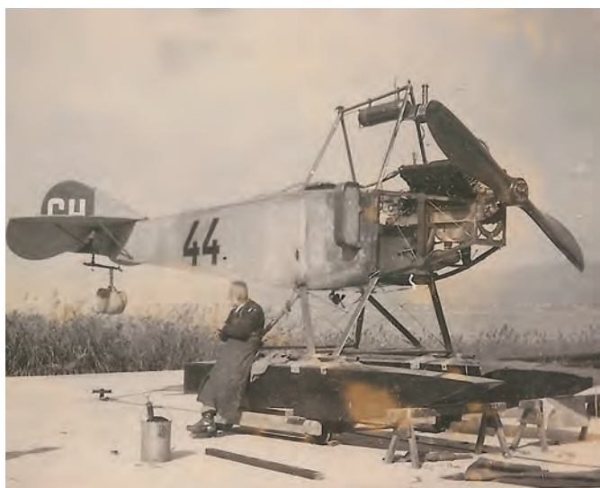
Alfred Comte rüstete seine Wild WT (Werknummer 21) CH-44 im Frühjahr 1924 mit Schwimmern aus. Der Doppeldecker verunfallte während der Erprobung auf dem Zürichsee.
