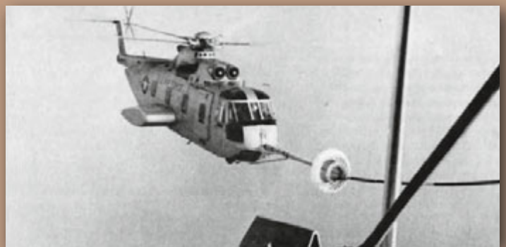
Vermutlich zum ersten Mal wurde ein Helikopter Sikorsky CH-3C im Flug betankt. Als fliegende «Zapfsäule» diente eine Lockheed KC-130F der U.S. Marines.
