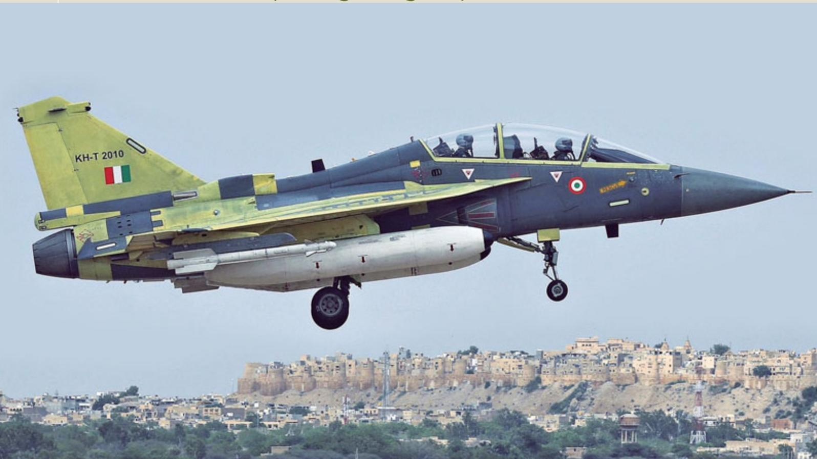
Der erste Zweisitzer-Prototyp PV5. Die Marineversion baut komplett auf diesem Rumpf auf, deren «buckliger» Einsitzer hat allerdings den hinteren Sitz mit Avionik verbaut bzw. keine Kanzelhaube.
