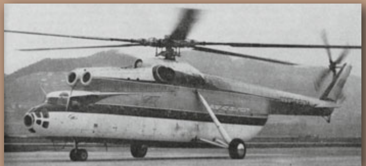
Der Mil Mi-6 CCCP-06174 auf dem Berner Flughafen. Er war während rund zehn Jahren der weltweit grösste Helikopter und konnte eine Nutzlast von bis zu 12 Tonnen transportieren.
