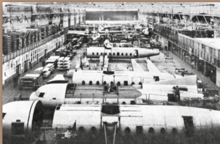
In der Montagehalle von Fokker in Amsterdam wird das erfolgreiche Kurzstreckenverkehrsflugzeug Fokker F-27 Friendship zusammgebaut.
