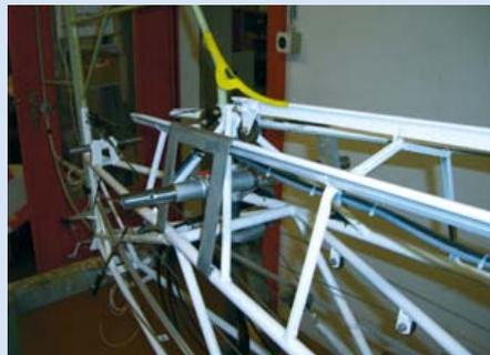
Die elektrischen Kabel und die Kabelzüge sind wieder verlegt, der Rumpf ist nun bereit zum Eintuchen.
