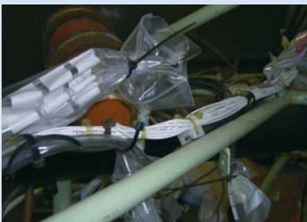
Alle Seilzüge und Kabelstränge mussten vom Rumpf gelöst und ausgebaut werden.
