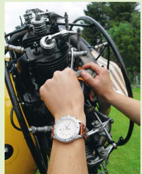
Oben: Kerzen wechseln und Kipphebel schmieren – das tägliche Brot der zwei Bücker-Langstreckenpiloten.
