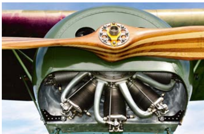
Die Motoren lässt Engels von Spezialisten bereitstellen. An Motoren aus dem Ersten Weltkrieg sind Flugrost und Unvollständigkeit das grösste Problem. Fehlende Teile müssen und können aber nachgefertigt werden.
