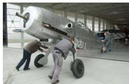
Ein Hauch von Big Brother: Der Rumpf der Bf 109 G-2 wird aus dem Container gerollt. Ausgleichsgewichte verhindern ein Überkippen des durch den Motor buglastigen Flugzeuges.
