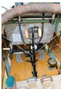
Spartanisches Cockpit: Zu sehen sind Kompass und Drehzahlmesser (hinter dem Knüppel). Die Firma Vision Unlimited produziert gegenwärtig eine internationale Fernsehdokumentation über die Anfänge des Fliegens am Beispiel von Fokker und der Arbeit des Fokker Teams Schorndorf. Cockpit wird die Sendezeiten kommunizieren.
