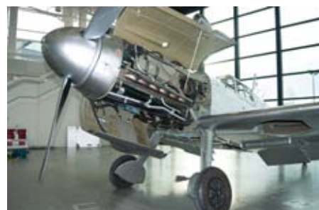
Bis zum Brandspant ist die Bf 109 G-2 komplett neu aufgebaut und mit einem Daimler Benz DB 605 Triebwerk versehen worden.
