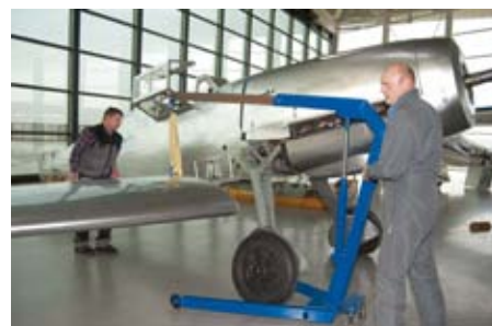
Hans-Ulrich Willbold (rechts) und Bernd Kurbeth bringen die rechte Tragfläche für den Zusammenbau in Position.
