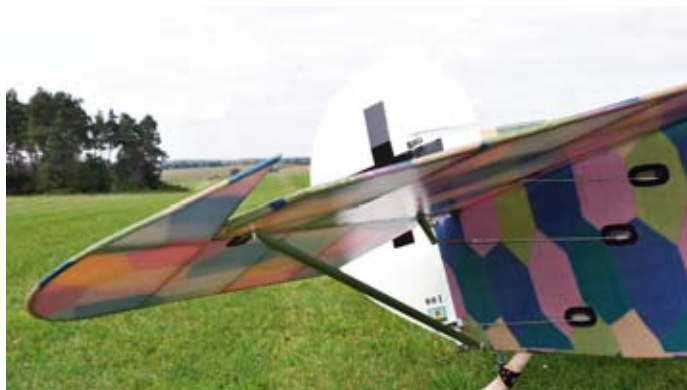
Der Sporn besteht aus Eschenholz, das gegen Splintern mit Bespannstoff umwickelt wurde. Das untere Ende wird aus einem Stahlschuh gebildet. Der Sporn ist un gelenkt, kann aber seitlich drehen und ist gefedert. Natürlich ist Asphalt damit Tabu.
