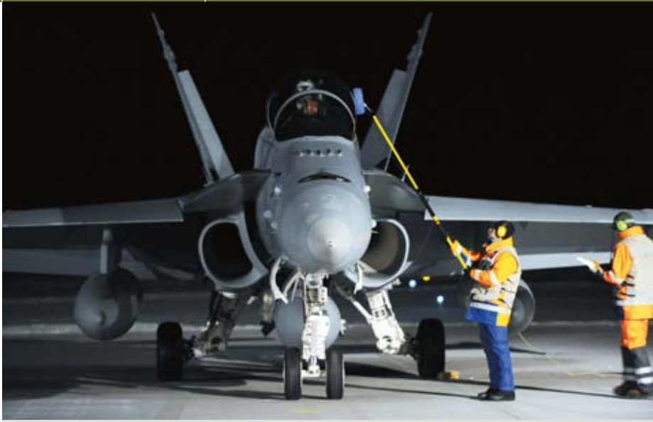
16 Uhr Lokalzeit, bei einer F/A-18 Hornet wird auf dem vereisten Vorfeld die statische Ladung vom Cockpitdach abgeleitet.
