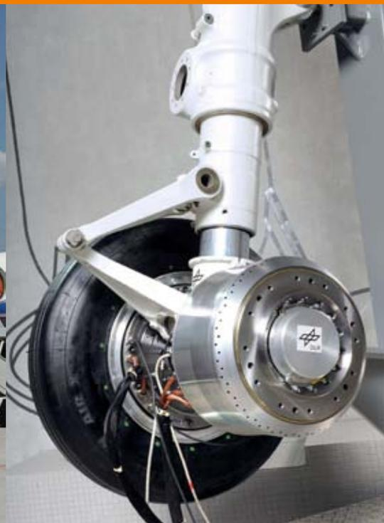
Das Testflugzeug ATRA, ein Airbus A 320 des DLR, wird hier mit Schlepperkraft bewegt. In den ATRA wird das elektrische Bugrad eingebaut und im April getestet.
