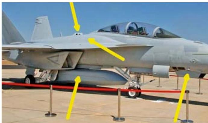
Die vier Pfeile bezeichnen die nun angebotenen «Roadmap»-Aufwertungen der Super-Hornet: Laserwarner, Rumpfsatteltanks, ein IRST-Gerät und einen «stealthy»-Waffenbehälter. Auch in bestehende «Super-Bugs» einrüstbar.
