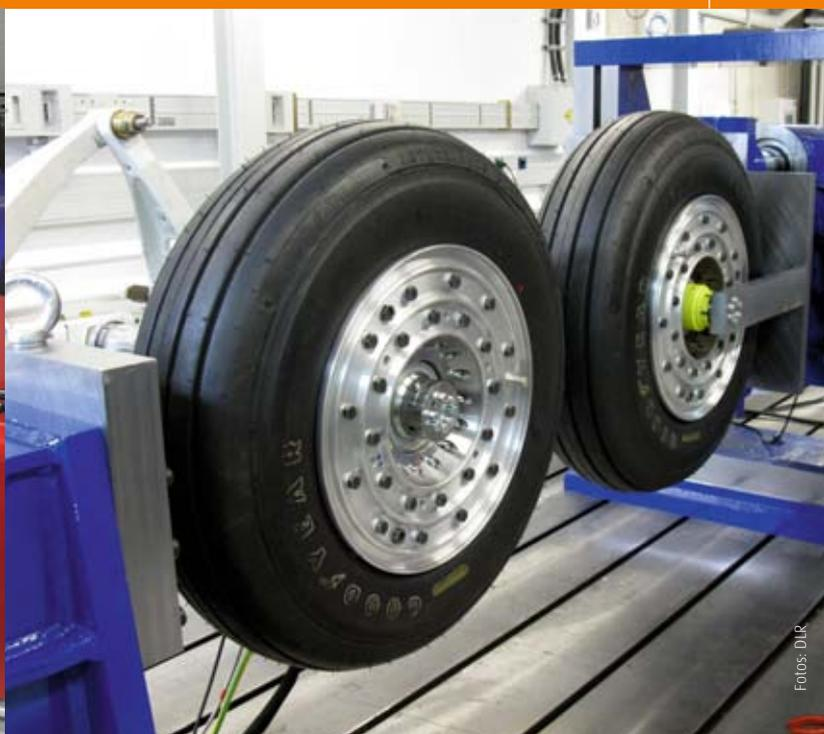
Rad-Prüfstand im DLR-Labor. Bis 70 Tonnen Gesamtgewicht können die beiden E-Motoren in den Radnaben bewegen.
