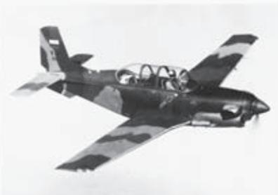
Verwandte: Sowohl die japanische Fuji KM-2 (oben links) als auch die Beech T-34 C-1 der Luftwaffe von Ecuador (oben rechts) wurden aus der Beech T-34 Mentor entwickelt. Während die KM-2 von einem 340-PS-Lycoming-Kolbenmotor angetrieben wird, verfügt die T-34 C-1 über eine Propellerturbine des Typs PT 6A-25, deren Leistung von 715 auf 400 WPS reduziert ist.
