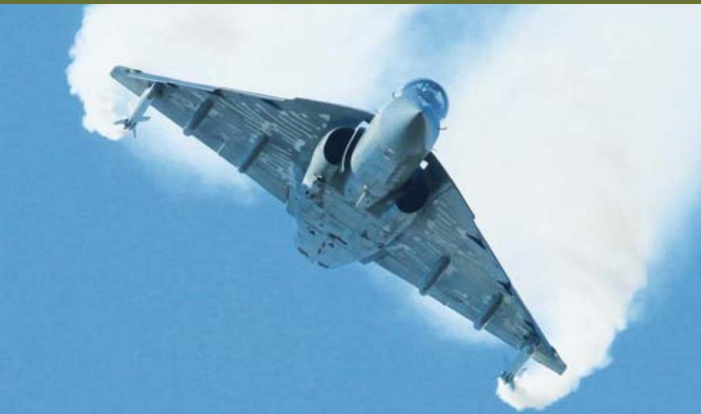
Das kleinste Kampfflugzeug der Welt, LCA-Tejas, wurde erst im Januar von der IAF akzeptiert, nach über 20 Jahren Entwicklung durch HAL. 100 Stück (Erstserie) werden vom GE404 angetrieben, die Zweitserie Mk.2 vom GE414. Das EJ-200 kam nicht zum Zug.
