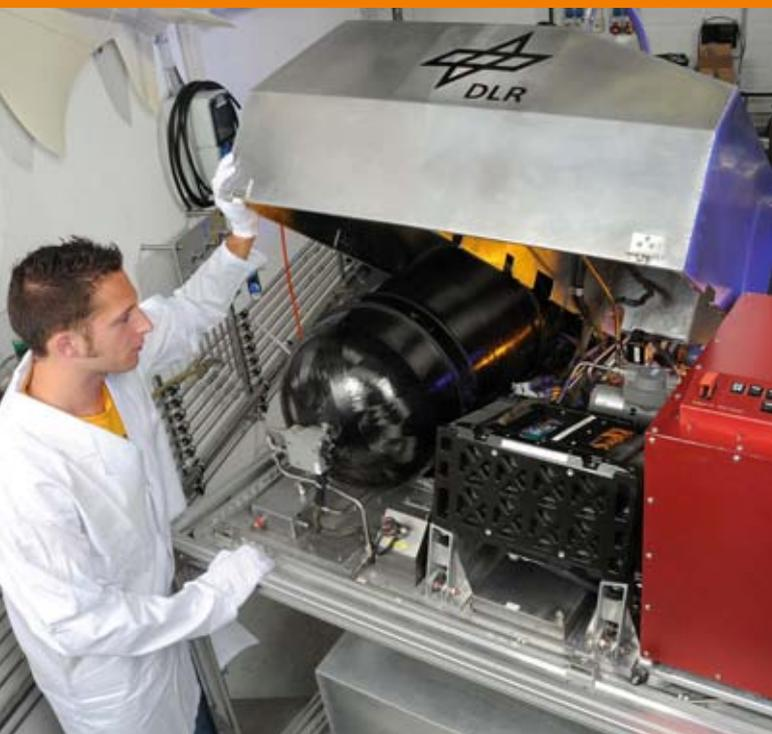
Wasserstoff-Brennstoffzellen-System im Frachtraum des Grossraum-Flugzeugs. Es soll nicht nur die beiden Radnaben-Motoren mit Strom versorgen, sondern später auch die APU ersetzen.
