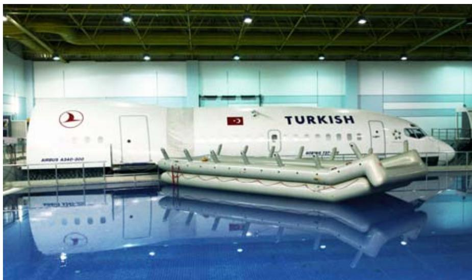
Mit dem für die Typen B737, A310, A340 ausgelegten Notfall-evakuierungssimulator lässt sich auch die korrekte Handhabung der Schwimmwesten üben.
