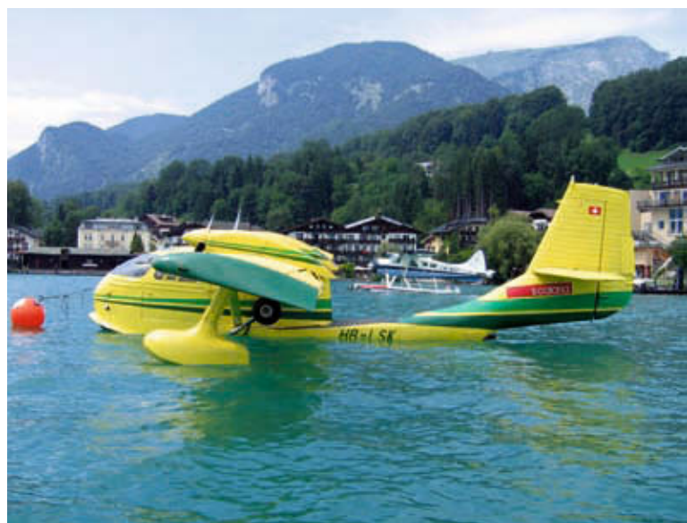
Statt eines 210-PS-Motors wie die SeaBee hat die TwinBee zwei mit je 180 PS.
