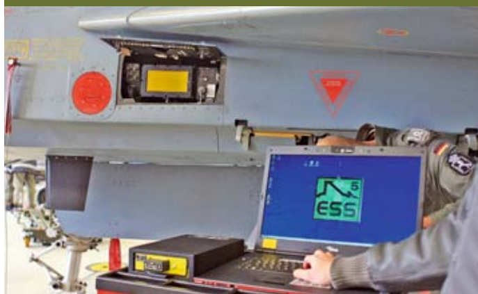
Von der ESS-Laptop/Brenner-Kombi werden die tagesaktuellen Daten...
