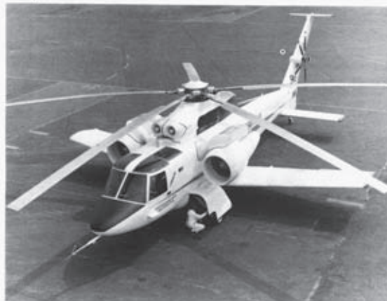
Das Versuchsgerät Sikorsky S-72 in der ursprünglichen Konfiguration als Compound-helikopter
