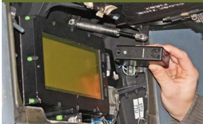
...auf einen zwei MB grossen PMDS-Stick geladen. Einschub links vorn unter der Flügelwurzel.
