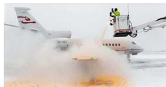
Bei der Enteisung des Falcons 900EX der Cat Aviation kommt das kleinere Gammafahrzeug zum Einsatz.
