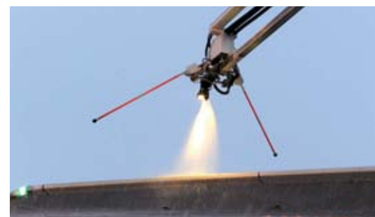
Detailansicht der Enteiserdüse, hier beim Anti-Icing-Einsatz.
