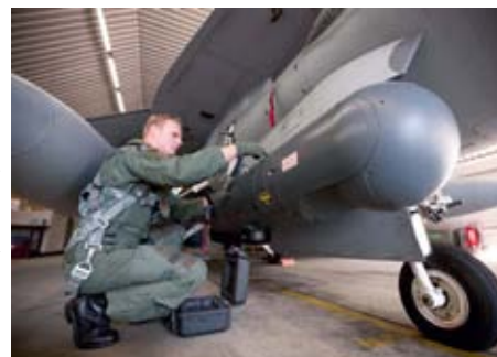
Vor dem Start setzt der Pilot einer beteiligten F-16 den Datenrecorder in den Aufklärungs-Pod. Der Pod wird grundsätzlich auf diesem Hardpoint vorne rechts montiert.
