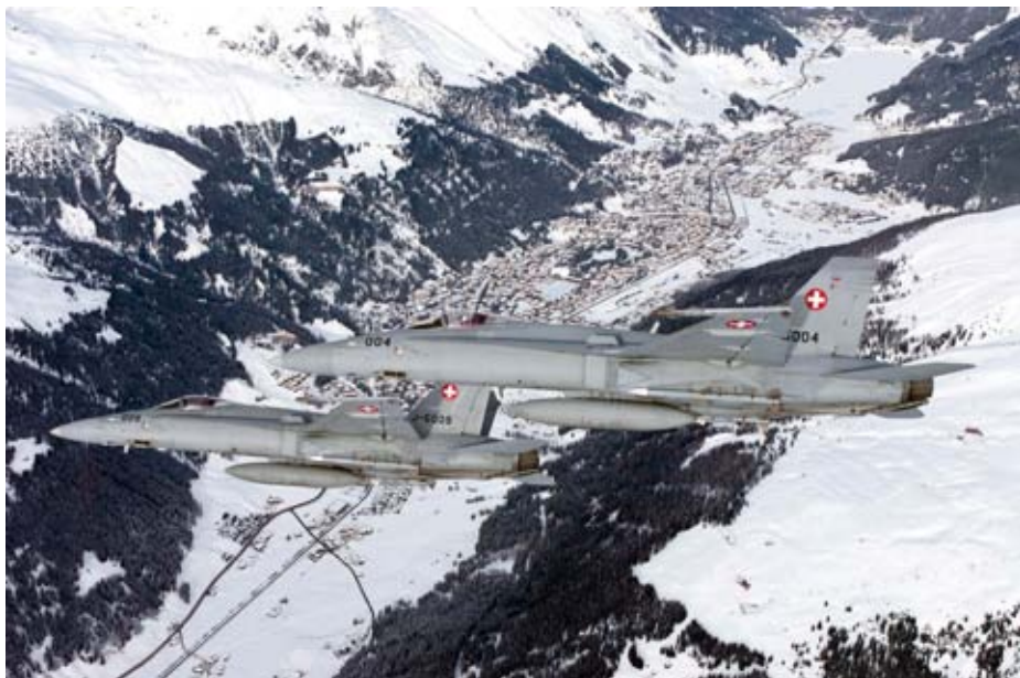
F/A-18C Hornet mit taktischen Lenk Waffen AMRAAM AIM-120B (am Rumpf) und AIM-9X (an den Flügelspitzen).
