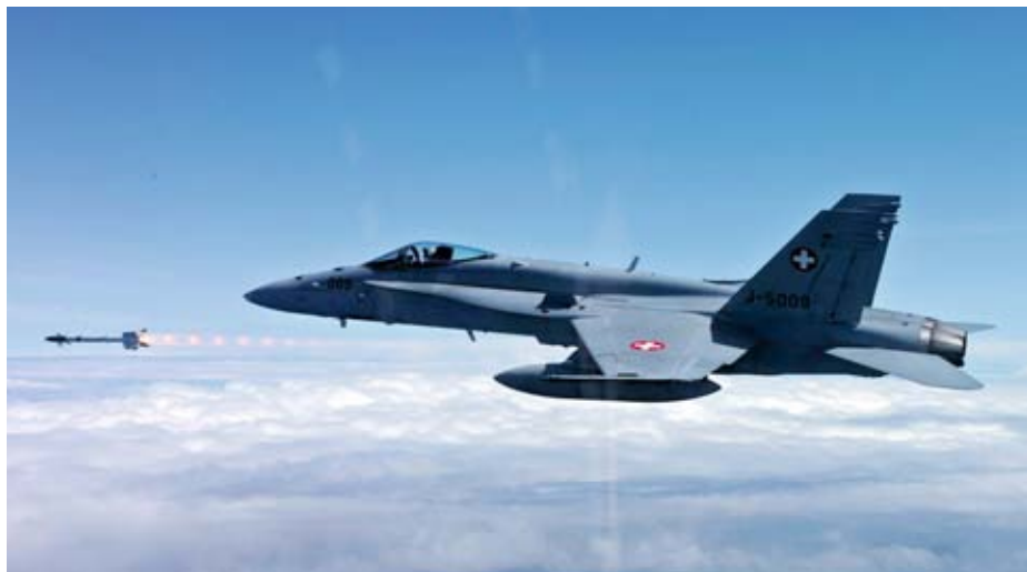
Abschuss einer AIM-9P-5 während dem Squadron Firing Wittmund im August 2009. Der Abschuss erfolgt von der Station 2 von einem Low Drag Pylon, LAU-139. Die AIM-9P-5 wurde für die Kampagne temporär auf die F/A-18 zugelassen.
