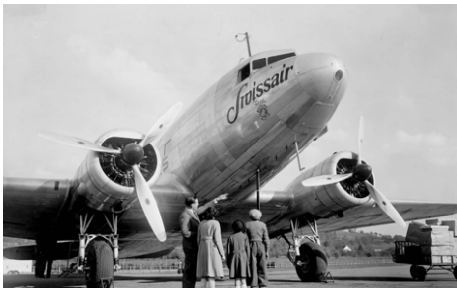
Die vor 75 Jahren an die Swissair abgelieferten ersten zwei Douglas DC-3-216 – im Bild die HB-IRA – besaßen noch die leistungsschwächeren Wright Cyclone GR-1820-G-2-Triebwerke mit einer Startleistung von 850 PS. Der Spinner auf dem Propeller fiel später weg.
