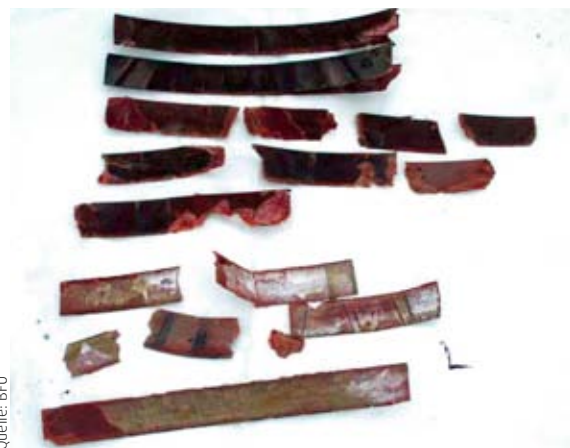
Alle abgelösten Eisschutzpanele des linken Triebwerks.
