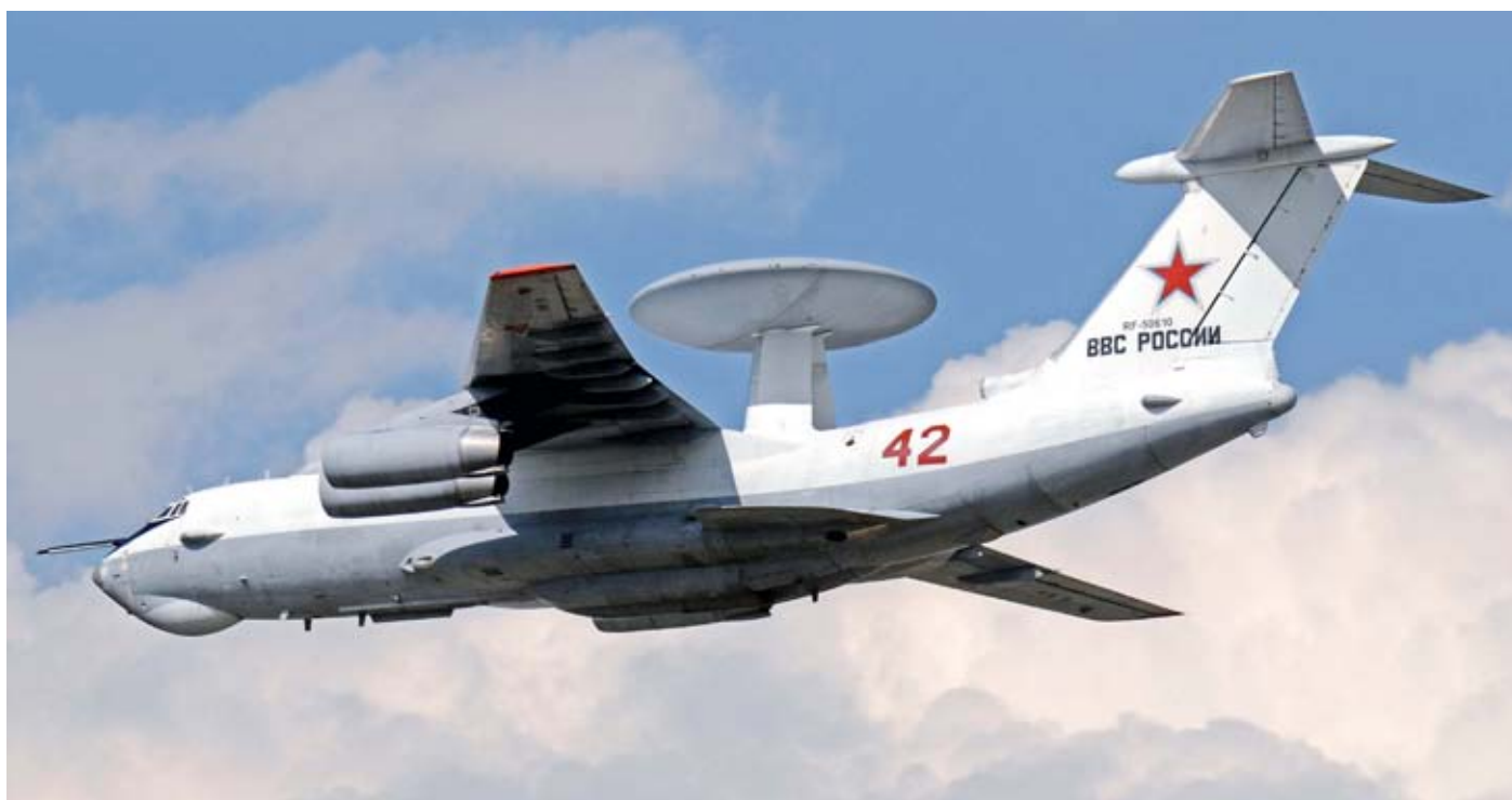
Die fliegende Radarstation Beriev A-50 wurde auf Basis des Transporters Iljuschin Il-76 entwickelt.
