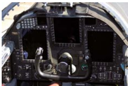
Das Glascockpit macht es den in ihren Bewegungen stark eingeschränkten Piloten deutlich einfacher.
