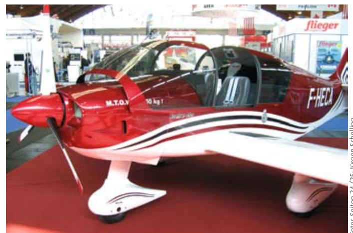
Die einstige Robin DR 400 feiert als Robin New Aircraft «Ecoflyer» mit einem 155-PS-Centurion-Diesel ihr Comeback.
