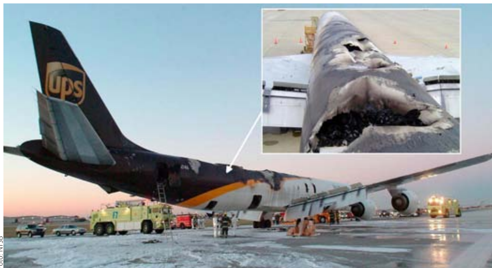
Ein Feuer wie das in der UPS DC-8-71 im Jahr 2006 in Philadelphia leistet der Feuerwehr nur dann vier Stunden lang Widerstand, wenn die «Brandbeschleuniger» schon im notlandenden Flugzeug mit dabei sind...
