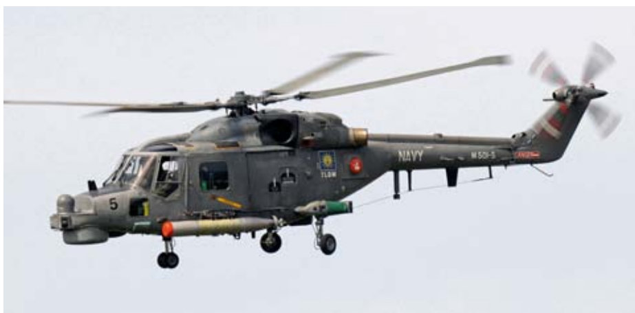
Eine der sechs Super Lynk Mk.100 der Royal Malaysian Navy. Für die U-Boot-Jagd können sie mit zwei Torpedos bewaffnet werden.
