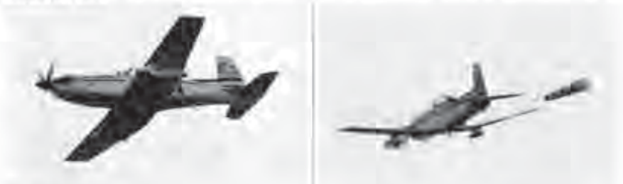
Die mit Schlepplinien ausgerüsteten Militärjets Pilatus PC-9 - hier mit FF-HPC/C-901 - stehen als Zielgruppenflieger der strategischen C-385.
