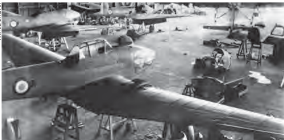
Die Potez 63 der Schweizer Fliegertruppe waren mit zwei Hispano-Suiza-14-Ab-Doppelsternmotoren mit einer Startleistung von 640 PS ausgerüstet, die auf eine Hispano-Hamilton-VIET-250 Luftschaube wirkten.
