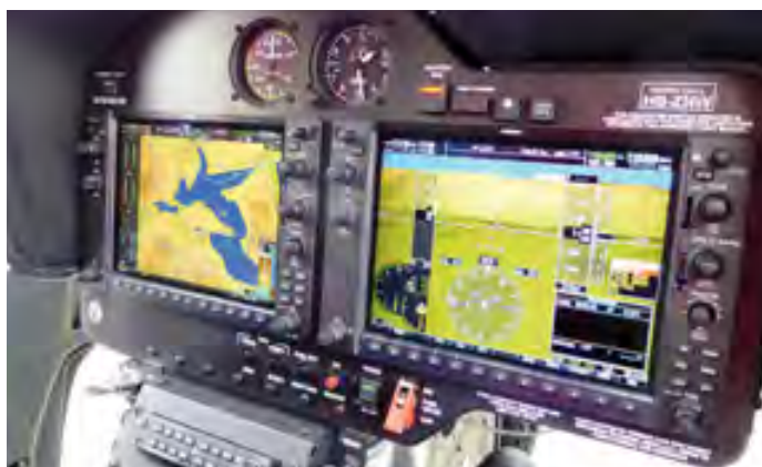
Cockpit der Bell 407GX, ausgerüstet mit einem Garmin G1000HTM.
