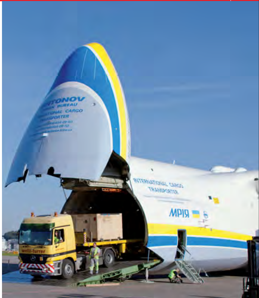
Mit Fahrzeugen lässt sich die Fracht über die einziehbare Rampe in den Frachtraum bringen.
