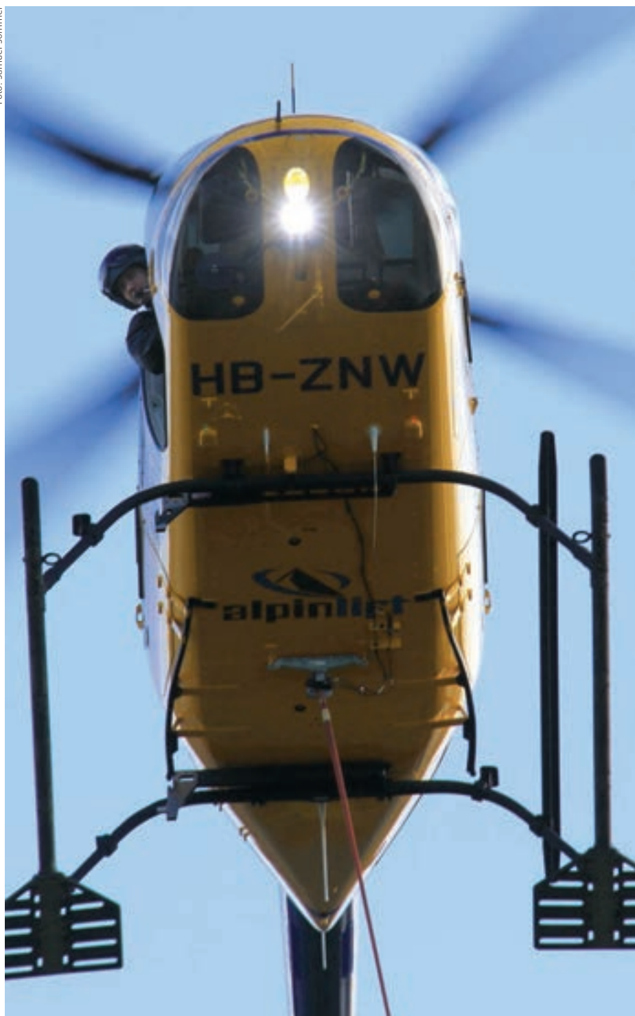
Verbesserte Sicherheit: Die zwei hellen Led-Landescheinwerfer sind selbst bei Tageslicht gut sichtbar.
