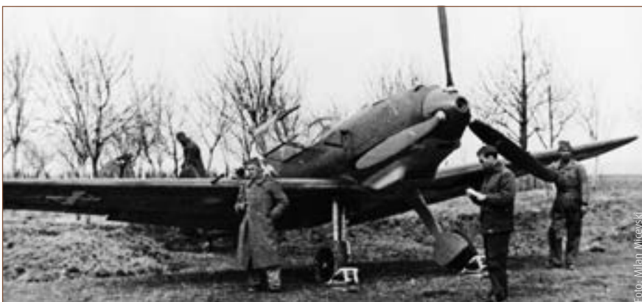
Diese mit dem taktischen Kennzeichen L-31 versehene Bf 109 E-3 (Werknummer 2530) gehörte zur 31. Lovacka grupa (31. Jagdflieger-Gruppe) und war mit zwei von der Zürcher Werkzeugmaschinenfabrik Oerlikon gelieferten M-39-E.K.-20-mm-Kanonen ausgerüstet.
