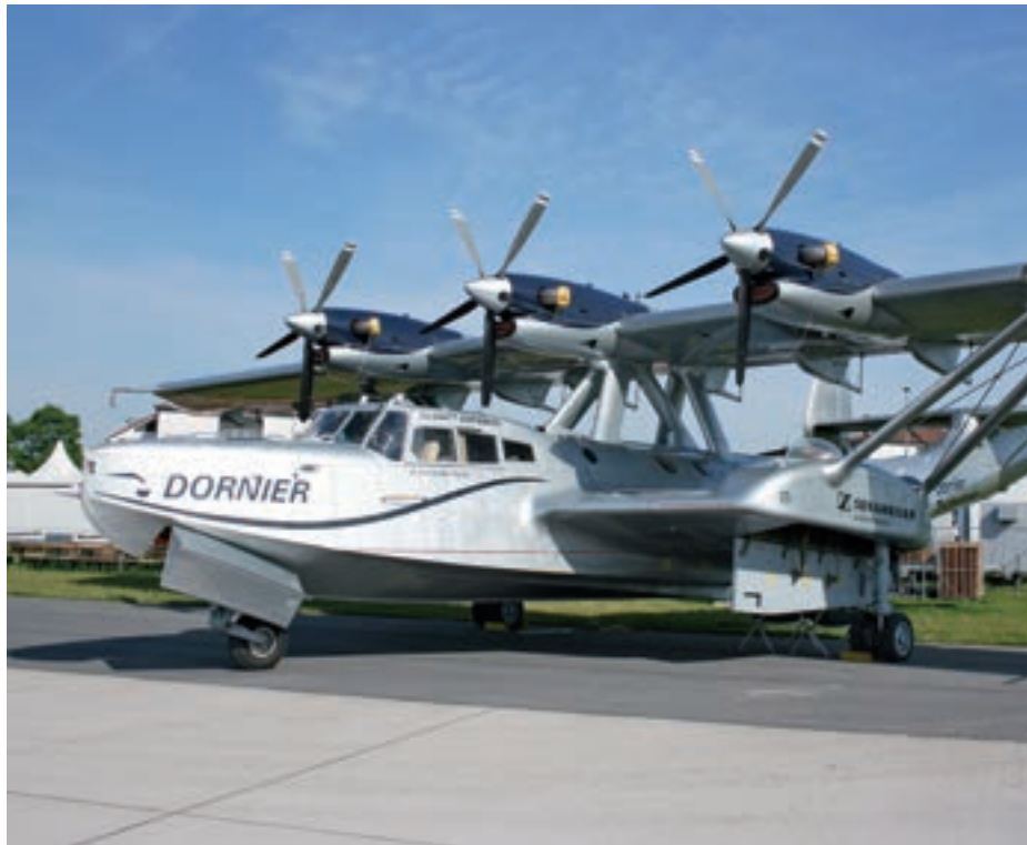
Do 24 ATT, ein von drei Fünfblatt-Propellern angetriebenes Amphibienflugzeug mit Baujahr 1944. Es ist weltweit das einzige Exemplar dieses Typs.
