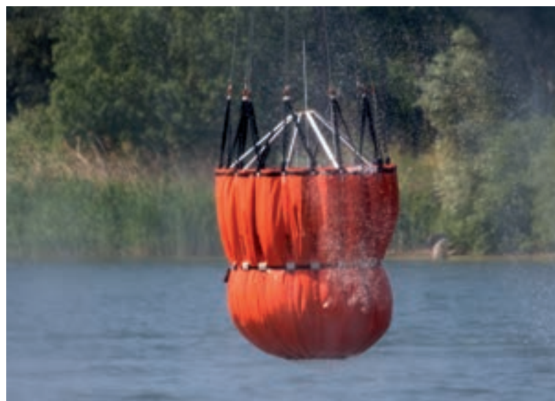
Der sogenannte «Bambi-Bucket», der Wassersack.
