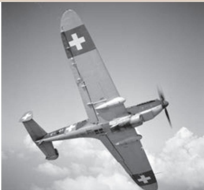
Die C-3603 war eine Entwicklung der Konstruktions-Werkstätte Thun. Der mit einem 1000 PS starken Hispano-Suiza HS-51 12 Y Triebwerk ausgerüstete Tiefdecker fand vor allem im Erdkampf und als Fernaufklärer Verwendung.
