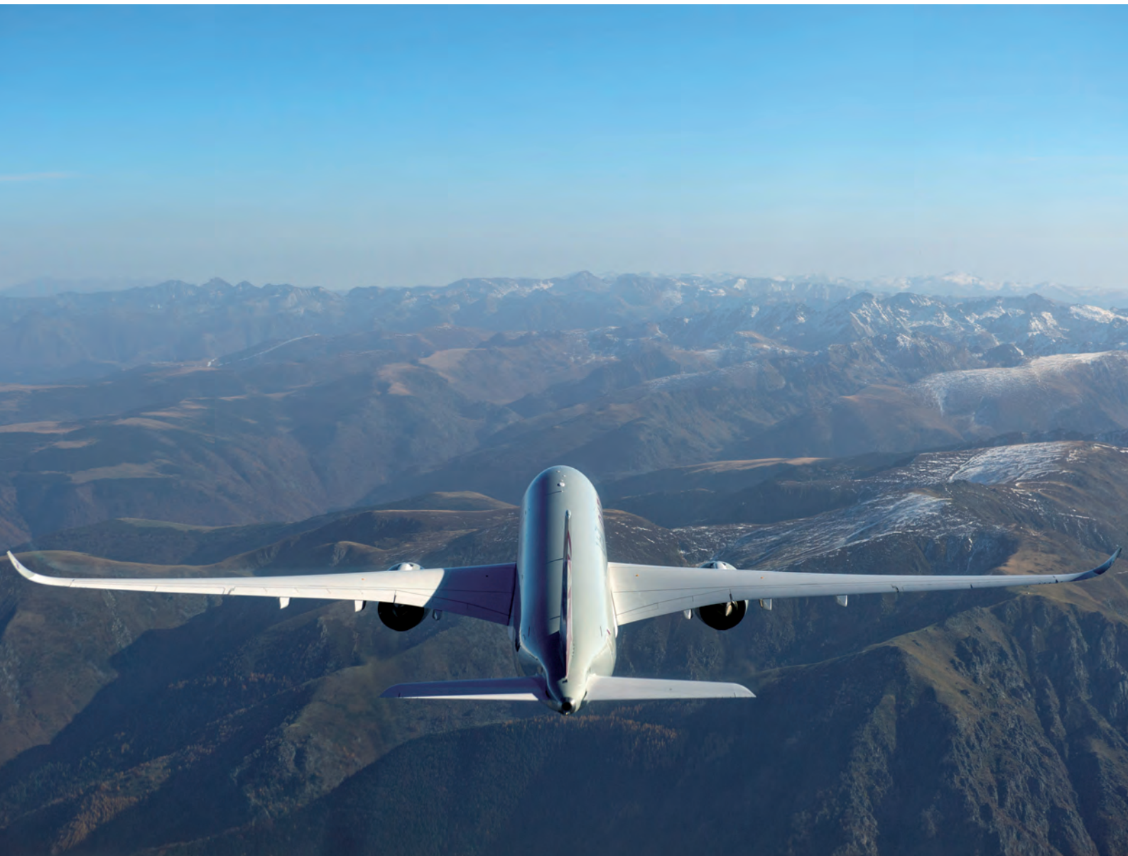
Oben: «Der zähe Kunde» Akbar Al Baker (links) zusammen mit Airbus-Chef Fabrice Brégier. Unten: Der Airbus A350 besteht zu mehr als 50 Prozent aus Kohlefaser, was ihn zu einem ökonomisch zu betreibenden Passagierflugzeug macht.
