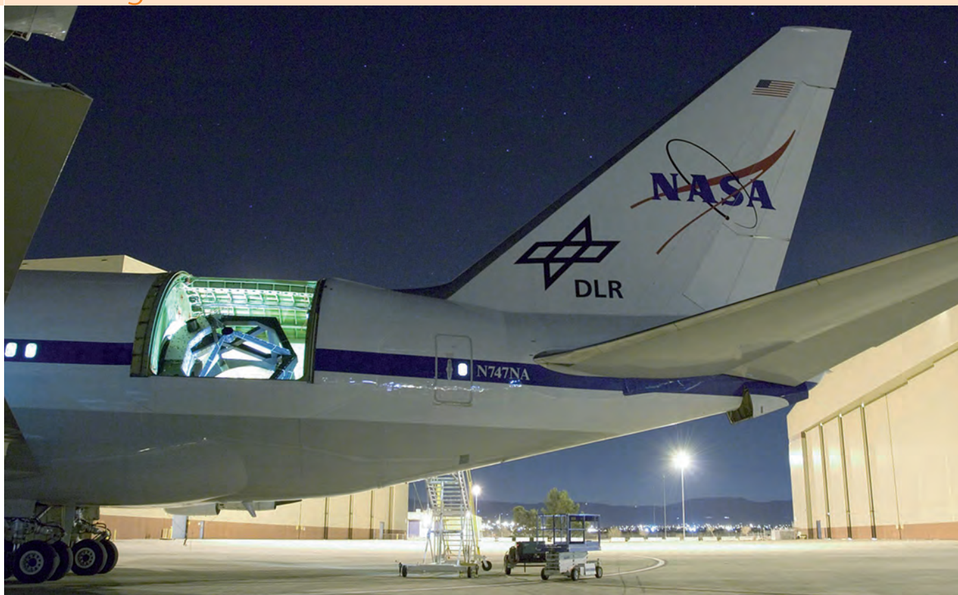
Das eingebaute Teleskop ist 17 Tonnen schwer und hat einen Spiegeldurchmesser von 2,7 Metern.
