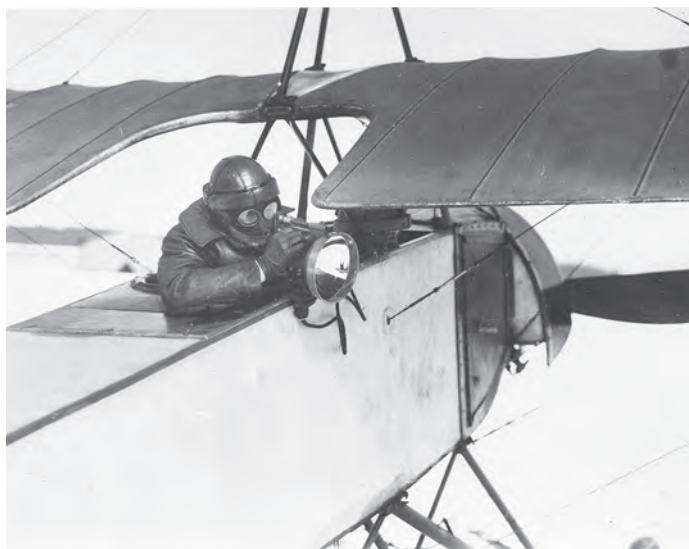
Typisch für die Morane-Saulnier Type L Parasol war die über dem Rumpf angebrachte Tragfläche, die dem Piloten für Aufklärungsaufgaben eine hervorragende Sicht nach unten verschaffte.
