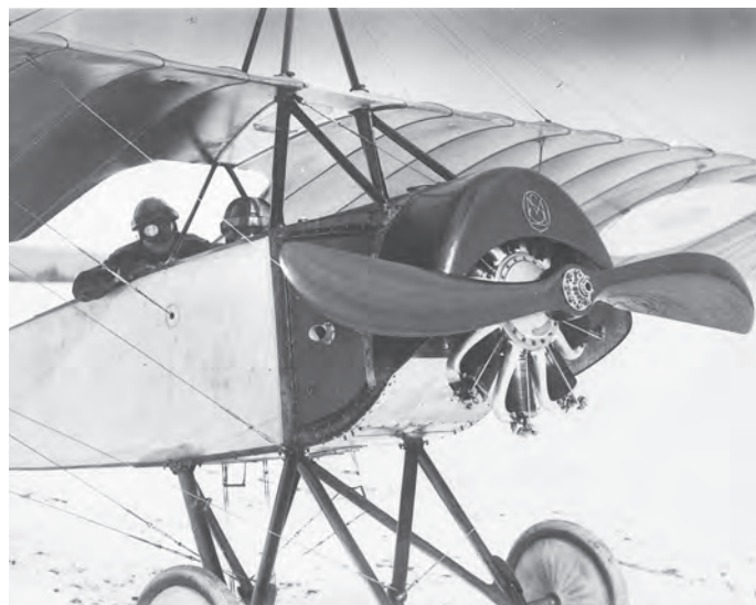
Die Morane-Saulnier Type L Parasol war mit einem Le Rhône 9C-Rotationsmotor mit einer Leistung von 80 PS ausgerüstet. Auf der Triebwerksverkleidung befindet sich das Logo des Herstellers.
