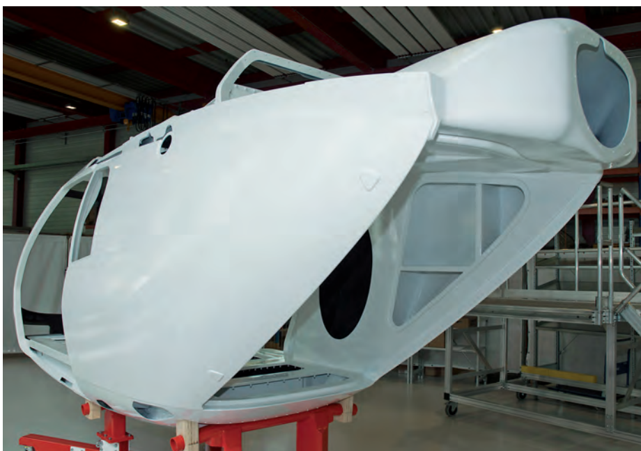
Beim Prototyp P2 wurden die ausklappbaren Tritte für das Wartungspersonal weggelassen. Dieses wird zukünftig über eine externe Leiter zum Triebwerksgehäuse gelangen.
