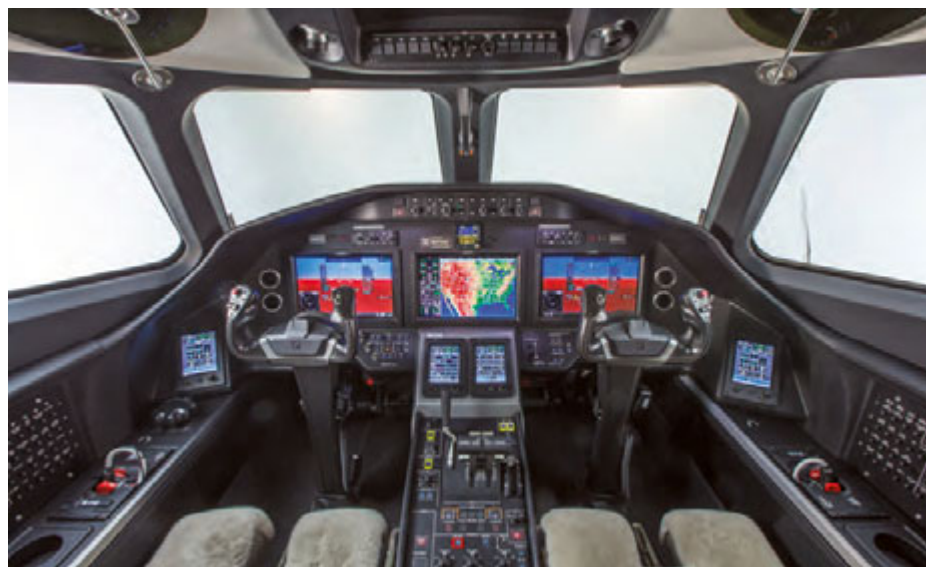
Das Cockpit ist mit einem Garmin G5000 mit drei Touch-Screen-Displays ausgestattet.
