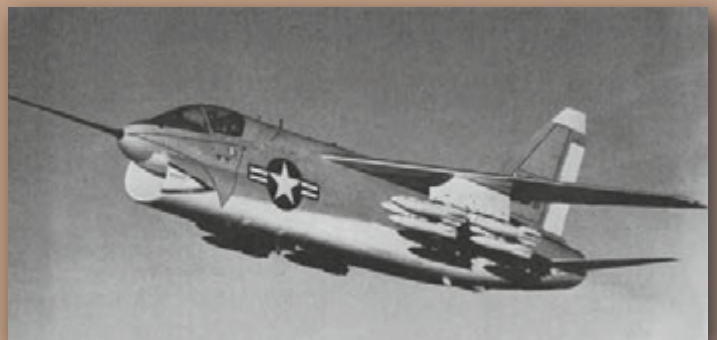
Der erste Prototyp LTV YA-7A-CV Corsair II mit einer Zuladung von insgesamt zwölf 115-kg-Bomben. Diese Maschine stürzte im Erscheinungsmonat des COCKPITs vor 50 Jahren ab.
