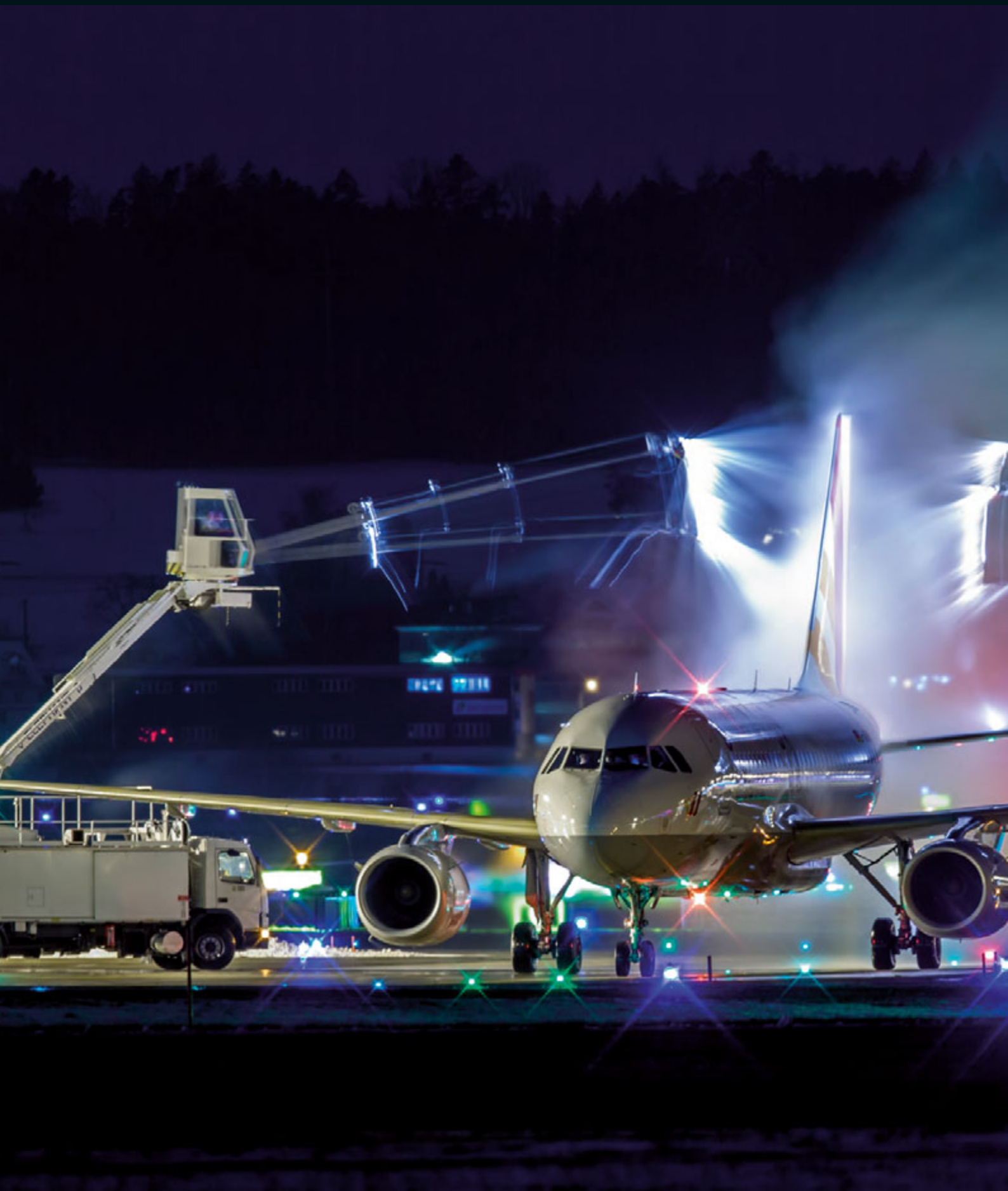
Zürich: Das Foto – eine Langzeitbelichtung – zeigt einen Airbus A320 von Germanwings, der am 17. Januar 2016 am Flughafen Zürich wegen der winterlichen Verhältnisse enteist werden musste. Bei diesem Vorgang wird mit einer heissen glykolhaltigen Flüssigkeit das vorhandene Eis entfernt. Mit einer weiteren Flüssigkeit wird anschliessend ein Schutzfilm aufgetragen, damit sich bis zum Start kein weiteres Eis bilden kann. Die Enteisierung findet auf den sogenannten De-Icing-Pads statt; die Flüssigkeit wird durch spezielle Fahrzeuge, sogenannte «Elefanten», aufgetragen. Foto: Christian Merz
