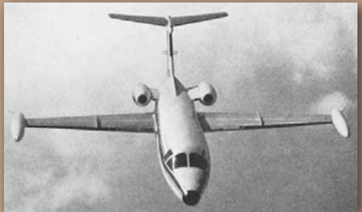
Typisches Merkmal der Hamburger Flugzeugbau HFB 320 Hansa waren die nach vorne gepfeilten Flügel. Projektleiter war der Schweizer Hans-Luzius Studer, der Chefkonstrukteur des P-16.
