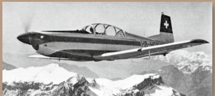
Die Pilatus Flugzeugwerke bauten in den Prototyp des P-3 HB-HON eine Propellerturbine ein und bezeichneten das Flugzeug als PC-7. Der erste Flug fand am 7. April 1966 statt.
