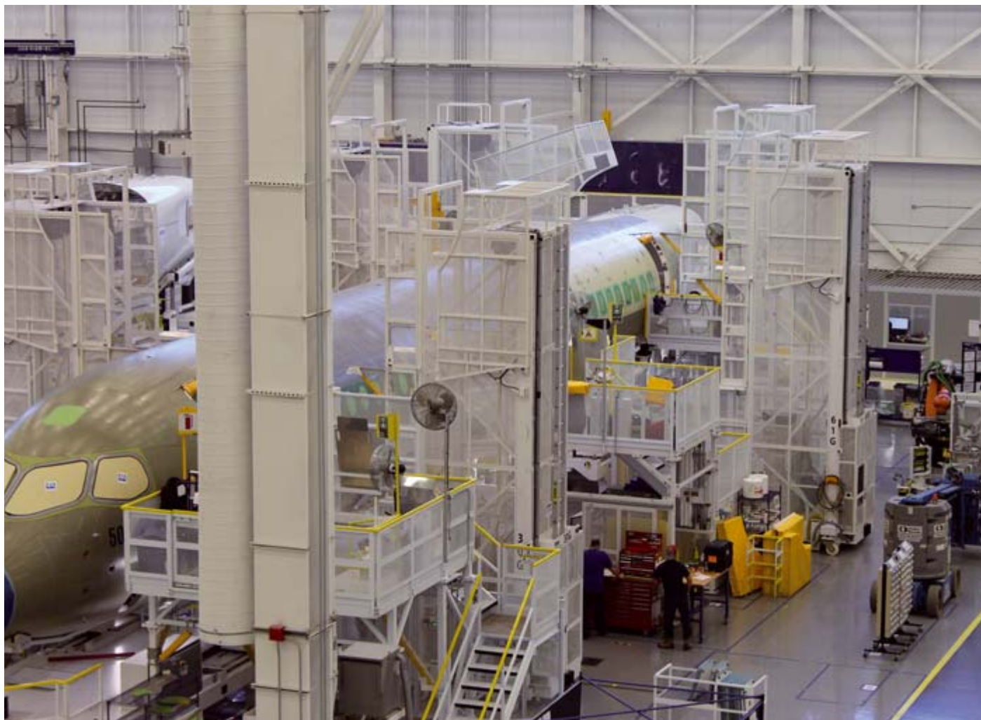
Roboter (weisse Türme) sorgen für höhere Präzision beim Zusammenbau des Rumpfs.
