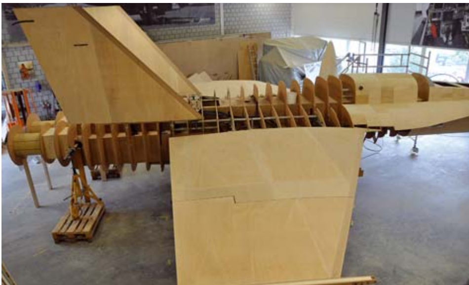
Ein Kampffjet aus Sperrholz entsteht: X-5098, das zweite Hornet-Mock-up im Rohbau.
