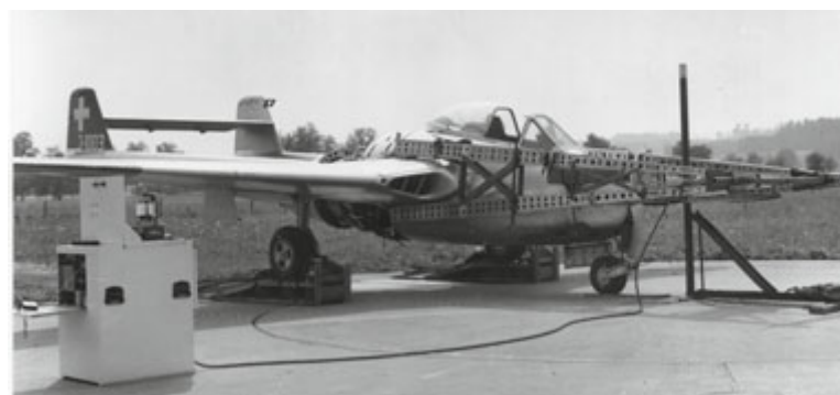
Die D.H. 100 Mk.1 J-1003 unterzog sich am 23. Juni 1947 auf dem in der Nähe von Luzern gelegenen Flugplatz Emmen einer Schubmessung des De Havilland Goblin 2-Triebwerks.
