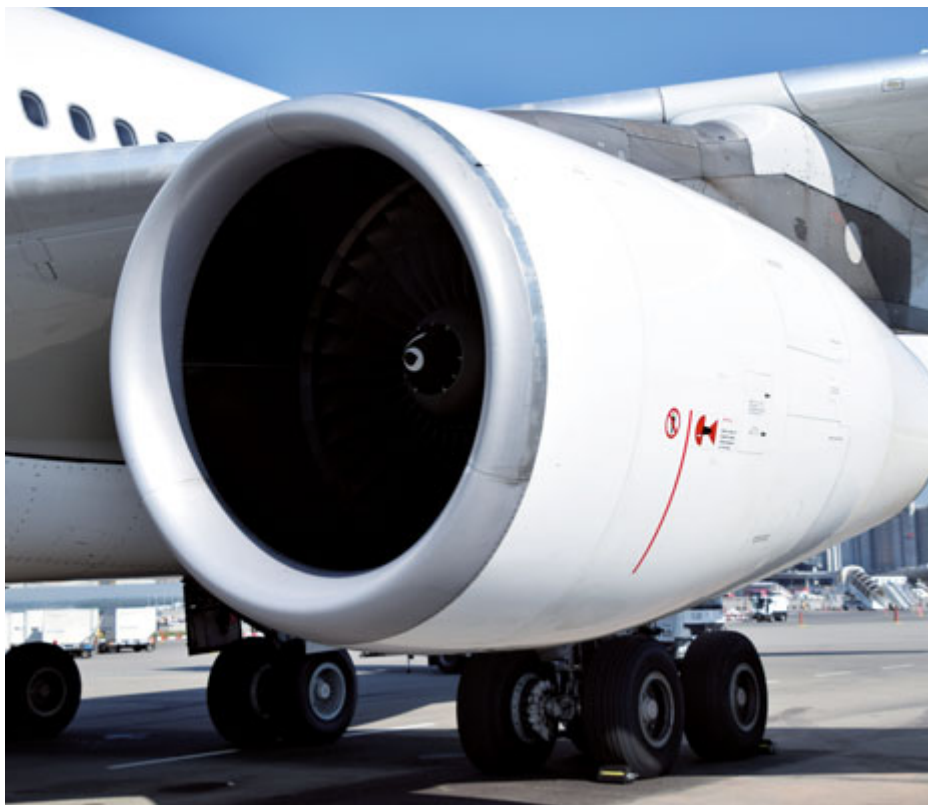
A340-Triebwerk. In der Mitte ist das zusätzliche zweirädrige, ungebremste Hauptfahrwerk zu sehen, das typisch ist für die A340.
