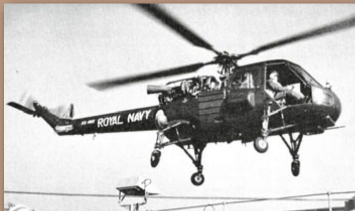
Die aus dem Scout der englischen Armee entwickelte Westland Wasp HAS. Mk.1 wurde von der Royal Navy von Zerstörern und Fregatten aus zur Unterseebootabwehr eingesetzt.
