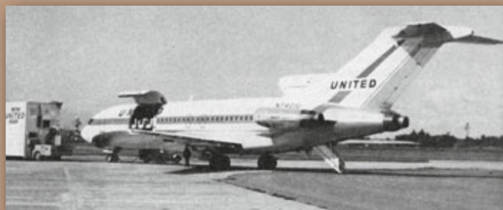
In die Boeing 727 QC wurde im Vorderrumpf ein grosses Frachttor eingebaut. Bei Bedarf konnten so in kurzer Zeit einige Sitzreihen durch Frachtpaletten ersetzt werden.
