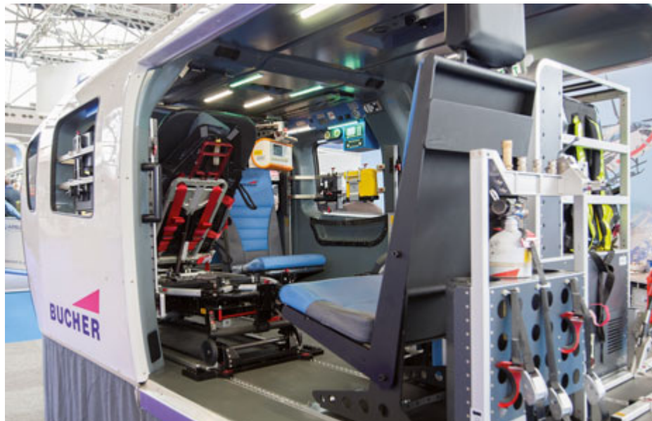
Originalgrosse Kabine des H145 mit medizinischer Ausrüstung von Bucher Leichtbau AG.
