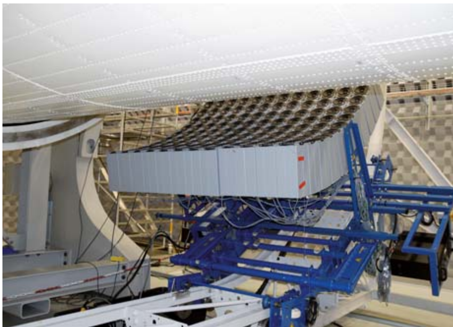
Mehr als hundert Lautsprecher, die einen Lärmpegel von bis zu 135 dB simulieren können, «umfahren» den Rumpf eines Verkehrsflugzeugs, um zu prüfen, welche Auswirkungen dieser Lärm in der Kabine hat. Rechts: ZAL-Geschäftsführer Roland Gerhards.
