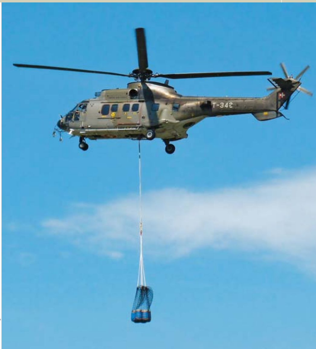
Die mittelgrossen Helikopter können am Lasthaken bis vier Tonnen Material transportieren.
